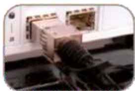
Figura 1. Instalando um Módulo SFP +
